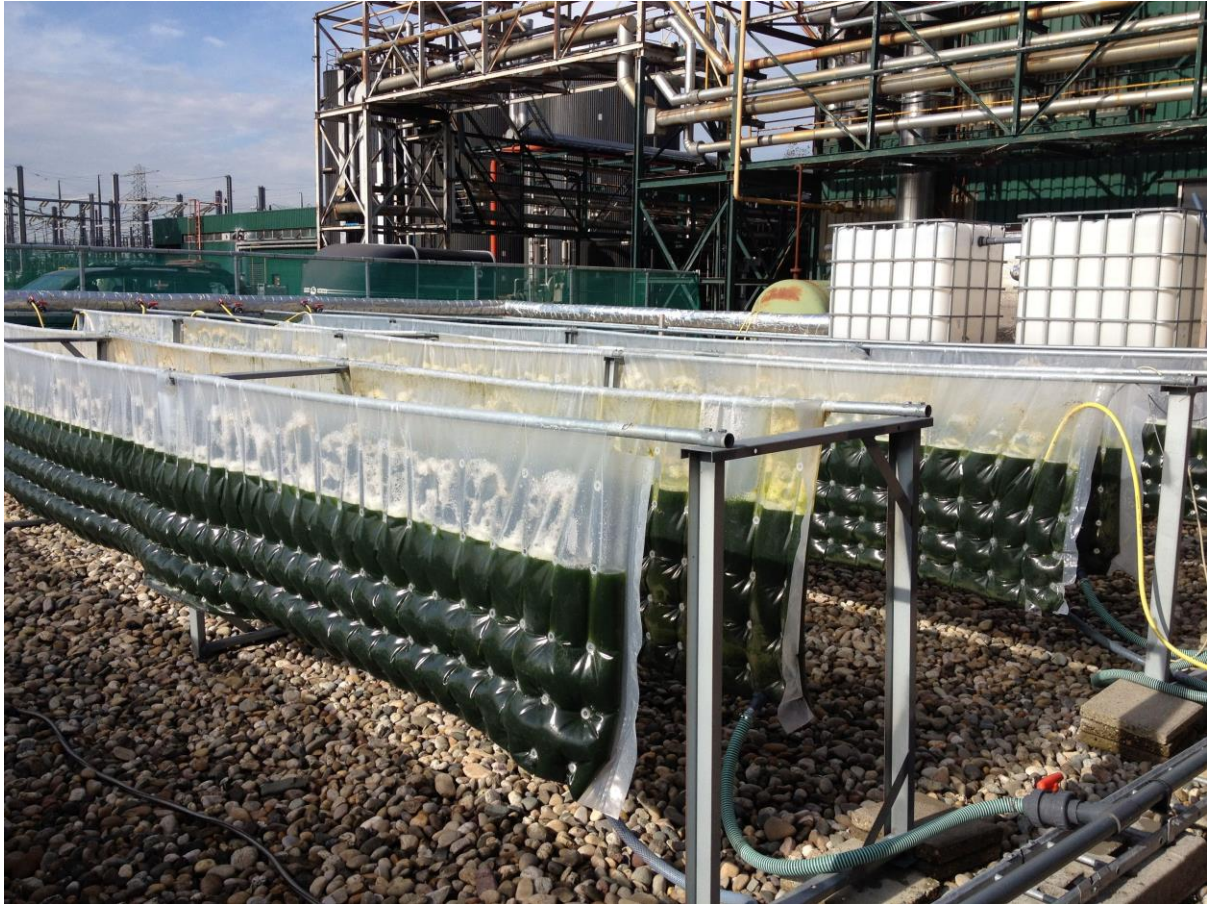
Figuur 5: Een proefopstelling waarbij rest-CO 2 van een fabriek wordt hergebruikt voor de kweek van algen is reeds gerealiseerd. (bron: Algaecom)
