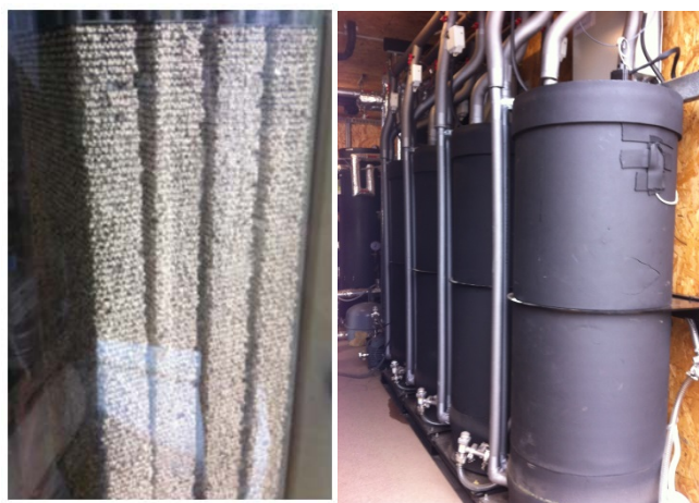
Figuur 28: Testopstelling van de thermo-chemische opslag ontwikkeld in het MERITS project ( www.merits.eu )
